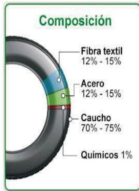
La estructura básica del neumático, que le proporciona la capacidad necesaria para soportar la carga y transmitir o absorber los esfuerzos de aceleración, frenado y guiado, está compuesta por aros metálicos y textiles de acero, rayón o polímeros sintéticos.
